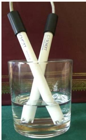
**IMPORTANT** : veuillez toutefois à changer l'électrolyte toutes les semaines si votre série de TP s'étale dans le temps. Cela vous permettra de vérifier l'état d'oxydation de la partie en argent de la sonde ainsi que l'état de la membrane de la tête de sonde.
